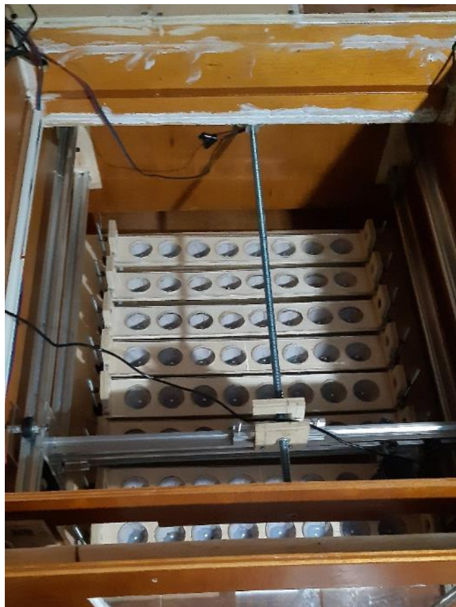
Figura 32. Sistema de Desplazamiento de la cámara.
