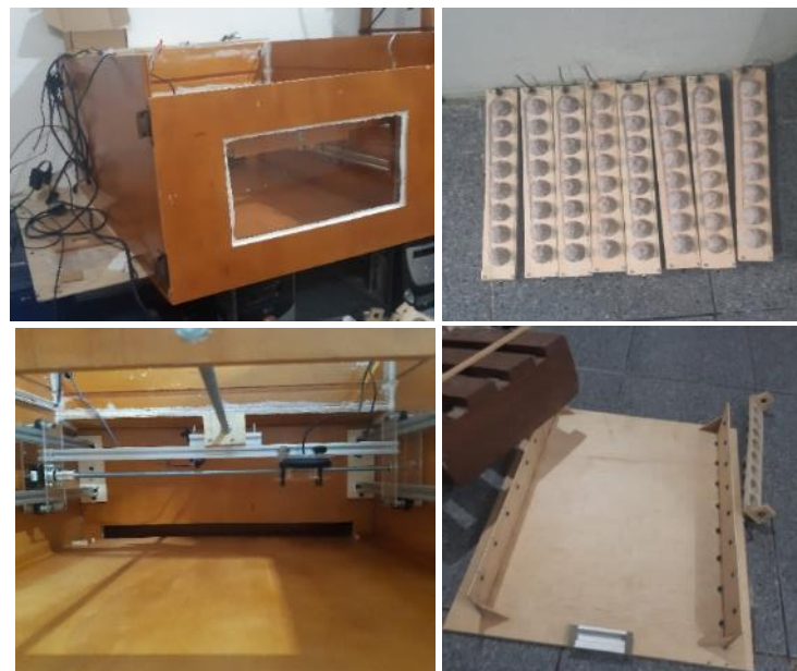
Figura 29. Armado de la Cámara de incubación, Cubeta para los Huevos y Estructura de Desplazamiento.
